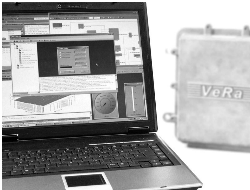
Abbildung 4.3: Entwicklungssystem VeRa bestehend aus Hardware und Software Toolchain
